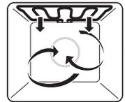
Il riscaldamento avviene mediante l'elemento riscaldante del grill. Il ricircolo uniforme dell'aria nella camera di cottura è garantito dal ventilatore dell'aria calda.
